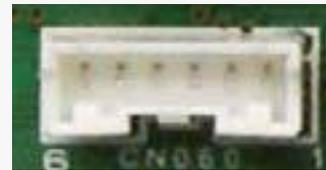
Anschlusstecker mit Litzen (1300 mm) zur Bereitstellung von Signalausgängen **PAW-OCT**
