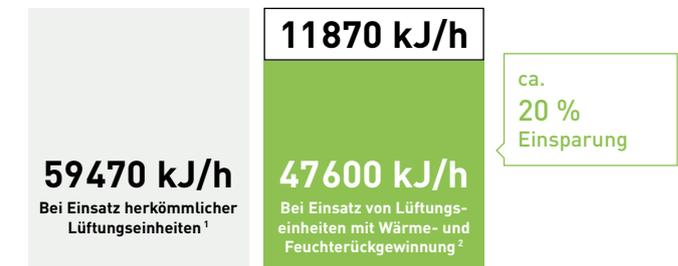
1) Zwei Geräte des Typs FY-27FPK7. 2) Nur ein Gerät des Typs FY-500ZDY8.
