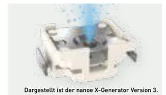
4 | Kein Filterwechsel, keine Servicearbeiten. Zur Erzeugung der nanoe™ X-Partikel (mit Hydroxylradikalen gefüllte Wassertröpfchen) wird die natürliche Luftfeuchte genutzt, die an der aus Titan gefertigten Zerstäubungselektrode kondensiert. Das nanoe X-System arbeitet also vollkommen wartungsfrei
