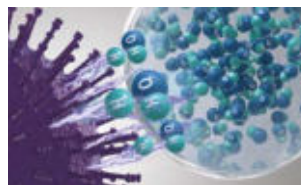
2 | Hydroxylradikale denaturieren die Proteine der Schadstoffe.
