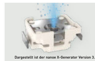
4 | Kein Filterwechsel, keine Servicearbeiten. Zur Erzeugung der nanoe™ X-Partikel (mit Hydroxylradikalen gefüllte Wassertröpfchen) wird die natürliche Luftfeuchte genutzt, die an der aus Titan gefertigten Zerstäubungselektrode kondensiert. Das nanoe X-System arbeitet also vollkommen wartungsfrei.
